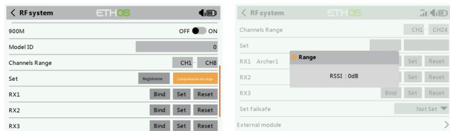
**Configuración del modelo para el módulo RF externo TANDEM X20S**
