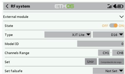
El módulo de RF externo puede encenderse o apagarse mediante software. El proceso de configuración es el mismo que para el RF interno. Los módulos externos deben estar cerrados cuando no estén en uso.
