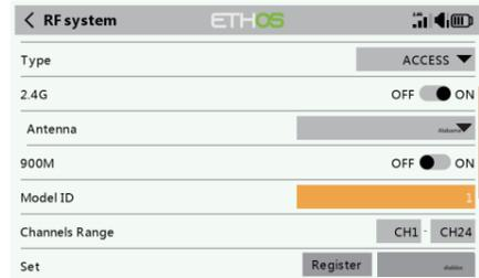
El sistema le asignará al receptor un número automáticamente, cuando cree un nuevo modelo y esto se puede cambiar fácilmente. El rango de ID del modelo es 00-63, con el número predeterminado 01. Una vez que el receptor se configura en el número deseado y se vincula al TANDEM X20S, no será necesario repetir el procedimiento de vinculación a menos que se cambie el número del receptor. En este punto, establezca el número de recepción en su número preferido y repita la operación de vinculación.
